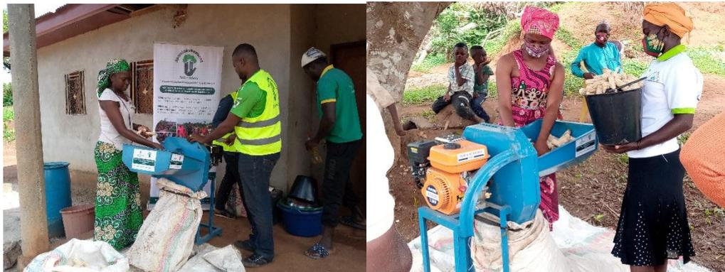
*Figure 3 : Opération de broyage des rafles*
